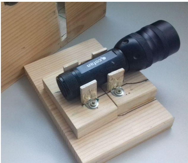
5.4. FIGURA 4. SISTEMA PER FER GIRAR EL MIRALL ORIENTADOR DEL FEIX DE L'ESPECTOFOTÒMETRE URV (ALMAZÁN MARTÍN, 2019)
