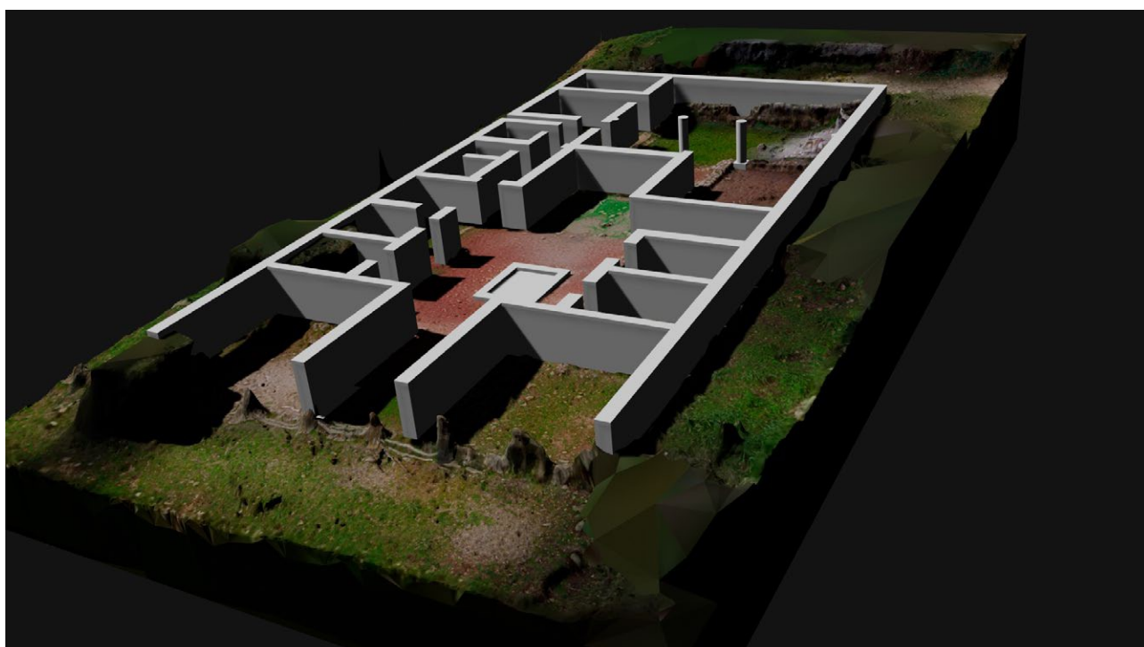
Figura 8. Modelo 3D de la casa de Diana y restitución de la fase augustea del edificio a partir de la planta publicada por Fentress.E (2003, 35 fig 15). Ambos integrados en Blender.
