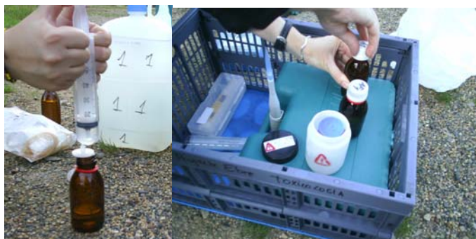
Figura 17- Filtració i acidificació de l'aigua fluvial per a determinar metalls en dissolució.
