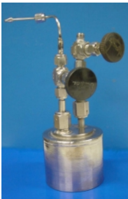
Figura 3.4: celda empleada para la preparación de las disoluciones \text{NH}_3 + \text{H}_2\text{O} + \text{hidróxido} .
