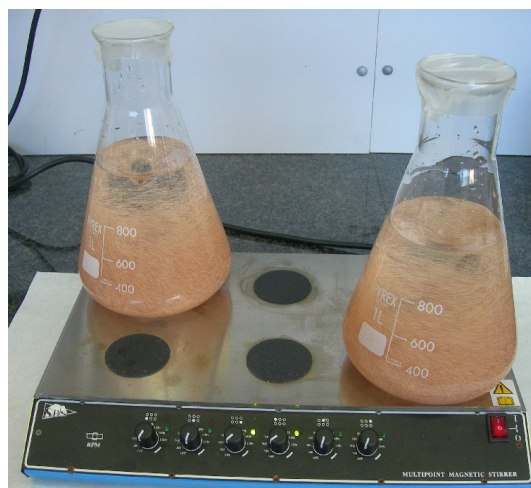
Figura 2.1. Sistema batch para la eliminación de plomo mediante resina de intercambio iónico Lewatit TP 207
